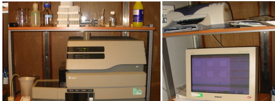
Figura 8. Citometro de flujo y ordenador con software para citometría
