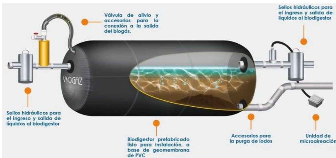
Figura 33. Esquema biodigestor de plástico. Fuente: PuentesDigitales, 2018
