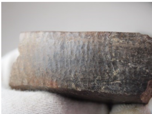
Figura 5.5. Detalle de pulido. Ejemplo de pulido en el que su confección buscar dejar una textura característica en la superficie.
