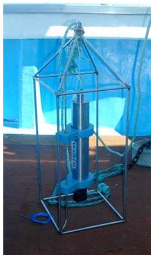
Figura 2b. Armadura de protecção do CTD
