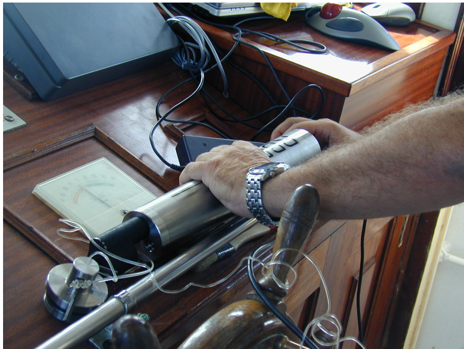
Figura 2. Descarga de los datos registrados mediante el dispositivo XR-420-CTD empleado para la toma de datos oceanográficos en todas las estaciones analizadas.
