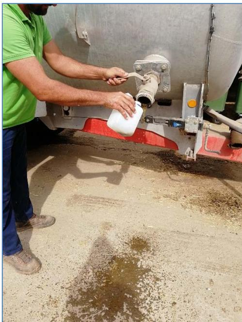
Figura 17. Punto de muestreo B1. Agua bombeada desde el depósito provisional al camión. Extracción del agua del camión.
