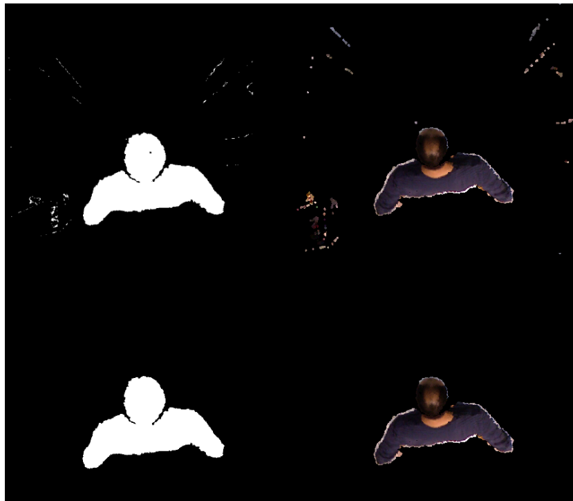
Figura 4.4: Resultado de la eliminación del fondo y del ruido restante en la imagen. En la parte superior tenemos el fondo eliminado, mientras que en la inferior se ha eliminado tanto fondo como ruido.
