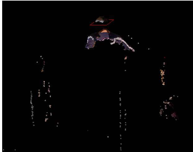
Figura 4.7: Porción de la cabeza de la persona desde una vista frontal que capturamos con Kinect y que tenemos en cuenta para realizar la segmentación.
