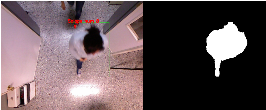
Figura 5.6: A la izquierda, imagen en la que se resalta una persona detectada. A la derecha, la máscara que representa el área de interés sin el fondo de la persona, tras realizar la operación de sustracción de fondo.
