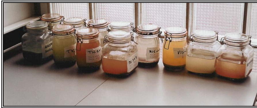
Figura IV.59. Recipientes con el contenido de los ensayos Batch de los Azulejos tras el proceso de lavado.
