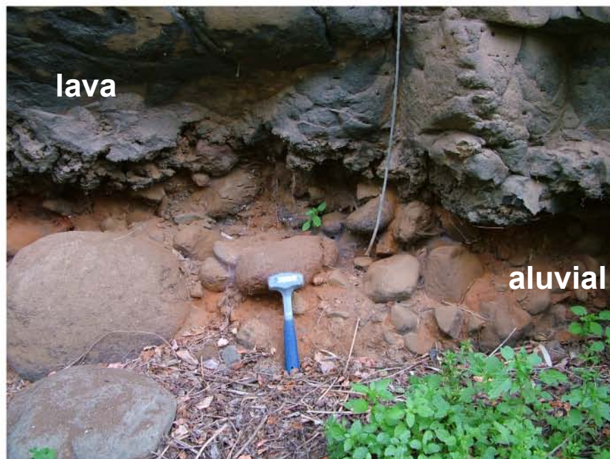
Figura 5.32: Detalle del contacto de lava (línea discontinua) con el aluvial previo del barranco.
