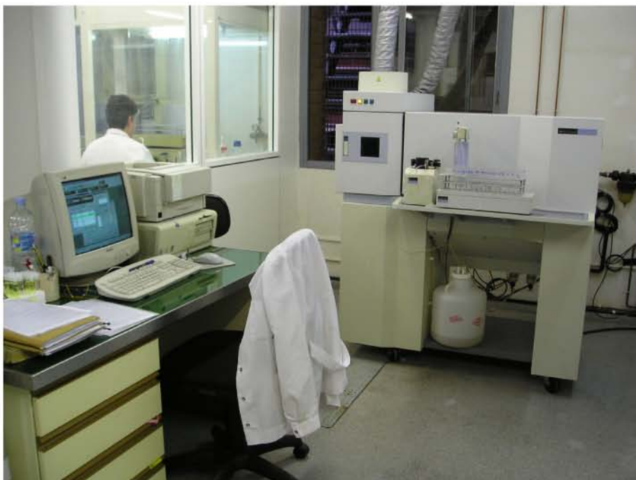
Figura 7.2: Espectrómetro de emisión atómica Perkin Elmer Optima 3200 RL (Servicios Científico-Técnicos, Universidad de Barcelona).
