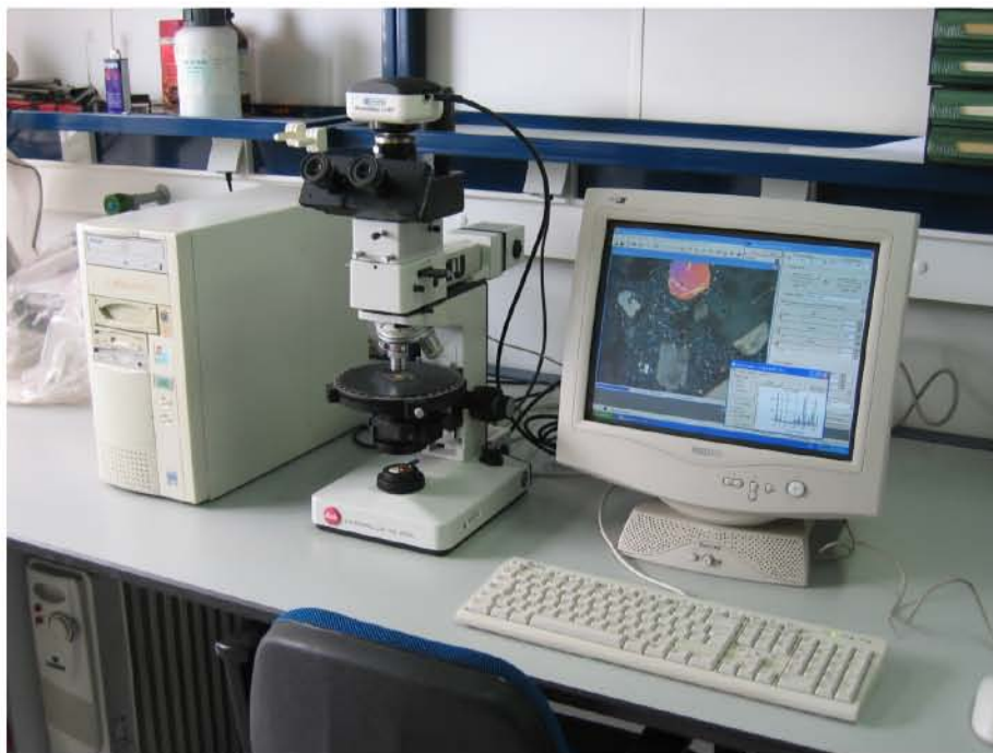
Figura 7.1: Microscopio petrográfico Leitz Laborlux 12 Pol y cámara de fotografía digital MicroPublisher 3.3 acoplada (Laboratorio de Geología, Departamento de Física, ULPGC).
