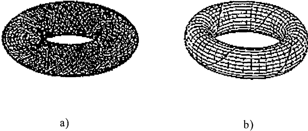
Figura 2.12: Evolución de un sistema formado por dos osciladores desacoplados: a) Comportamiento cuasiperiódico, (\frac{\omega_1}{\omega_2} \in \mathbb{R} \setminus \mathbb{Q}) ; b) Comportamiento resonante, (\frac{\omega_1}{\omega_2} \in \mathbb{Q}) . Fuente: Lorenz (1993).
