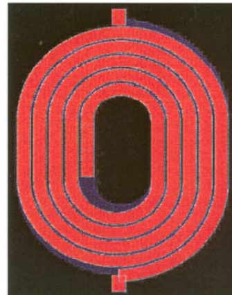
Figura D.40 Bobina Larga en Y, 1ª Espiral-METAL2 y METAL3, 2ª Espira-METAL1.
