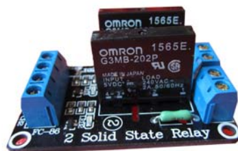
Figura 4. Réle de estado sólido Omrom G3MB.
