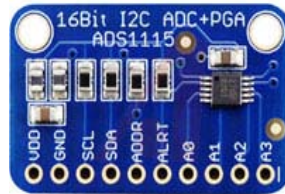
Figura 2. Conversor analógico-digital, ADS1115.
