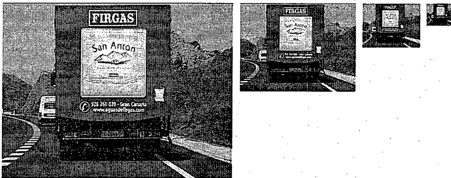
Figura 3.8: La figura representa a una misma imagen a resoluciones distintas. La búsqueda del objeto se realiza partiendo de la imagen de menor resolución (imagen más pequeña) donde se localiza burdamente el área donde se encuentra el objeto de interés para progresivamente ir refinando esta localización en las sucesivas imágenes de mayor resolución.
