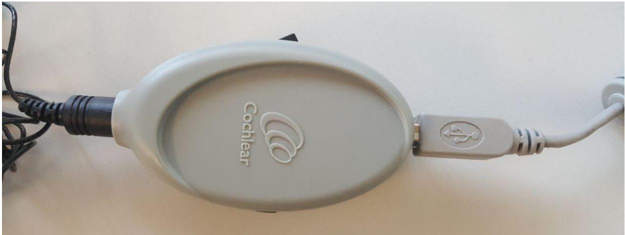
Ilustración 3-2: POD de interconexión.
