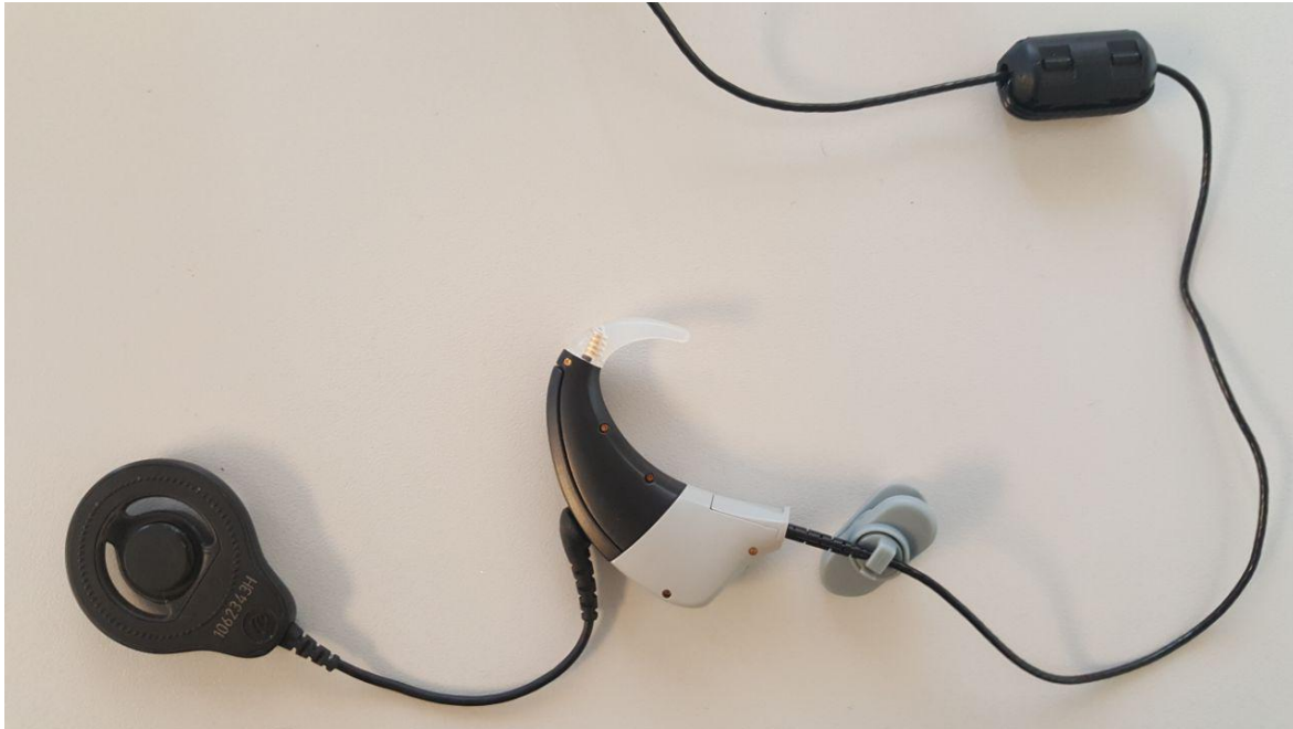
Ilustración 3-4: Bobina y procesador del implante coclear
