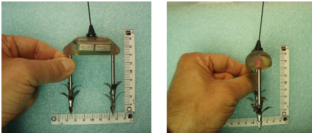
Figura 3.1. Tamaño de una marca satélite LIMPET SPOT 5 y de sus enganches de titanio.
