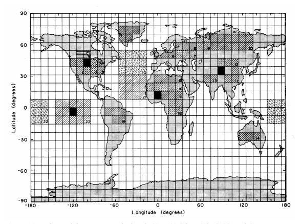
**Figura 11:** Red espacial para una resolución de 8° x 10° del modelo GISS Model II y por tanto del modelo EdGCM. El sombreado indica una de las regiones elegidas para diagnóstico de meses especiales. Las cuatro regiones en negro son elegidas particularmente de las cajas de la red para diagnósticos cada hora.
