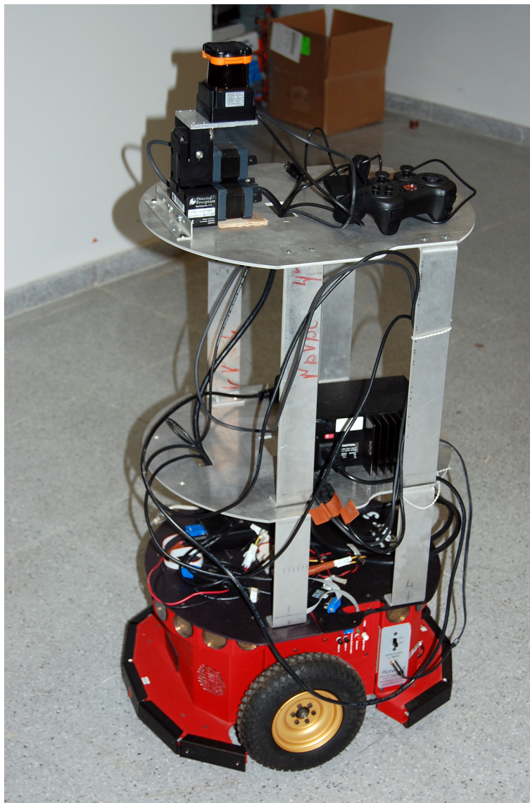
Figura 2.1: Sistema formado por el Robot Pioneer P3-DX, el sensor láser Hokuyo UTM-30LX y el dispositivo apuntador Directed Perception PTU 46-17.5. El sensor láser y el dispositivo apuntador se observan sobre la plataforma a la izquierda. A la derecha de ambos, el joystick inalámbrico
