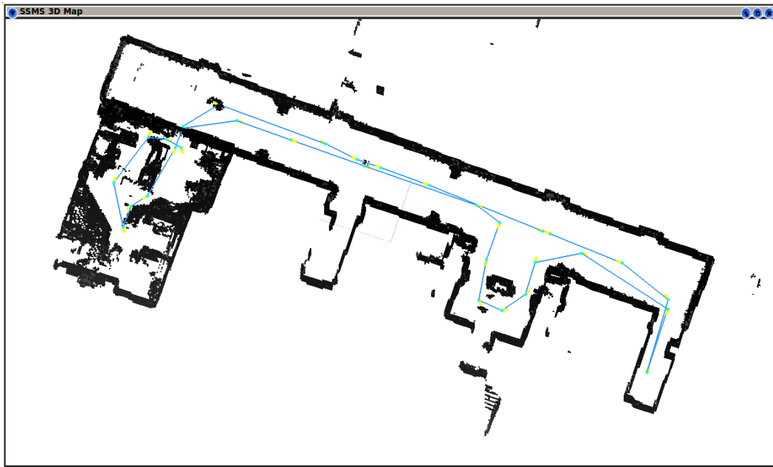
Figura 5.11: Vista aérea oblicua del mapa de superficies multinivel conjunto para el pasillo y el laboratorio tras ser corregidas las posiciones por el algoritmo SLAM 6D. La línea marca la trayectoria seguida por el robot y los puntos la posición desde la que se tomó el scan
