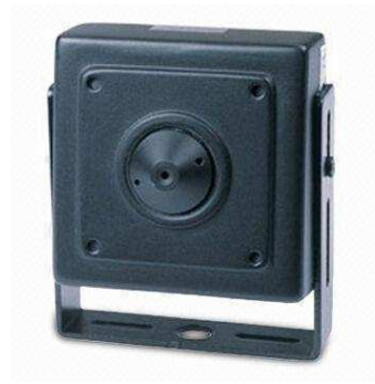
Figura 1.2: Mini Cámara Sony Color, instalada en posición cenital en el avión.
