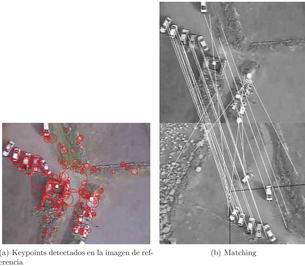
Figura 5.11: Emparejamientos con la imagen de referencia y una imagen de test aplicando la herramienta SURF implementada en OpenCV en el subconjunto 2.
