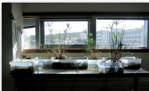
Imagen 1. Reactores utilizados en los estudios de los tratamientos biológicos.
