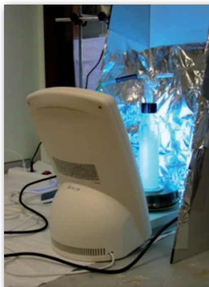
Imagen 2. Reactores utilizados en los estudios de los tratamientos fotocatalíticos.
