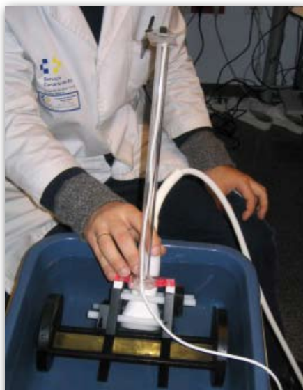
Figura 3. Maniqué de Cambridge: el transductor va montado sobre una base móvil con ruedas, dirigido hacia una lámina de latón. El sistema está inmerso en una cubeta llena de agua.
