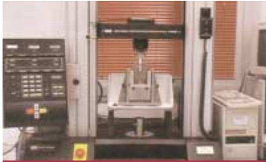
Figura 1. Texturómetro universal provisto de célula Warner-Bratzler.
