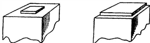
Figura 3.11. Representación simple del desarrollo de un núcleo superficial. El núcleo se extiende hacia toda la superficie del cristal
