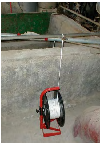
Figura 41.- Uso de sonda eléctrica en ensayo de bombeo de pozo (Foto del autor)
