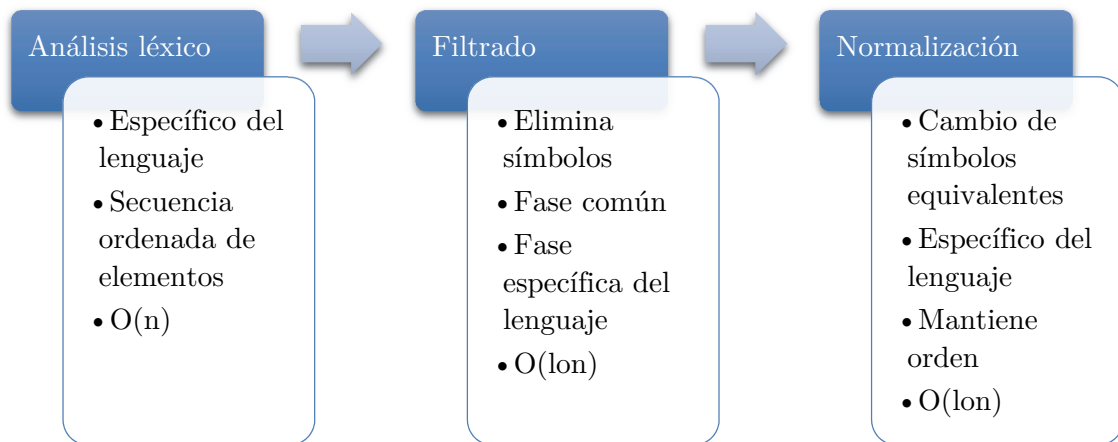
Figura 63 Fases del troceado
