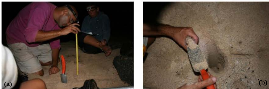
Fig. 14.- Regogida de muestra. (a) Medida de la profundidad y (b) posterior recogida de muestra.
