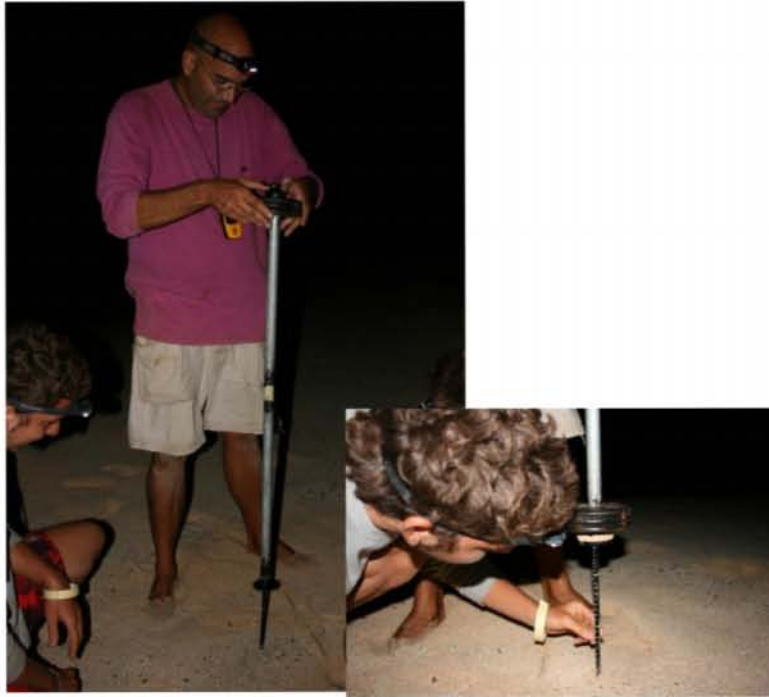
Fig. 17.- (a) Prototipo para medir in situ la porosidad de la arena. (b) Detalle de la toma de la medida de cuanto se hundía la barra de hierro en la arena.
