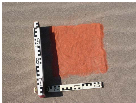
Figura 2.6. Forma de inyección del trazador en la zona del experimento.
