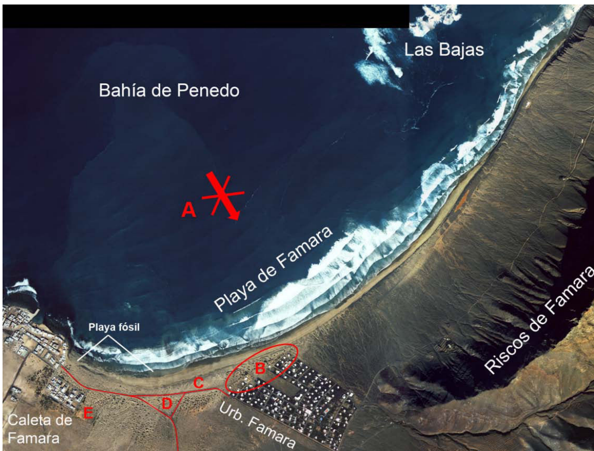
Figura 6.7. Localización de la problemática del sistema playa-duna de Famara. A- Falta de aportes; B- Acumulación de sedimentos en la urbanización Famara; C-Sustrato de cantos rodados; D-Carretera que atraviesa el sistema de dunas; E-zona colonizada por especie invasora.
