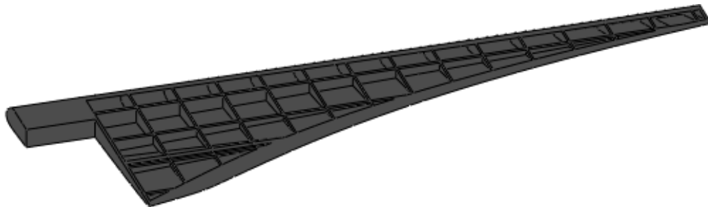
Ilustración 51. Sección del diseño óptimo de la pala (5 variables).
