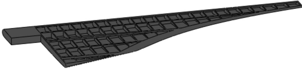
Ilustración 48. Sección del diseño óptimo de la pala (3 variables).
