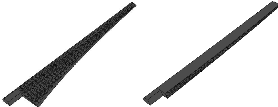
Ilustración 14. Vistas seccionadas de la geometría con estructuras celulares en el interior.
