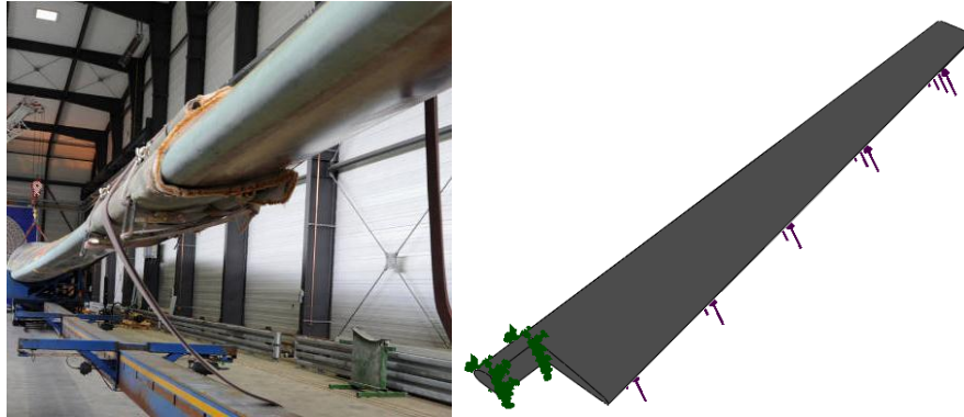
Ilustración 13. Ensayo a flexión de pala real de aerogenerador (izquierda) y simulación a modo de ejemplo para la geometría de referencia (derecha).
